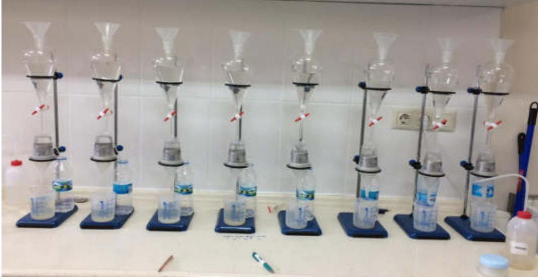
Şekil 10. Hidrolik iletkenlik analizi için kullanılan düzenek.
