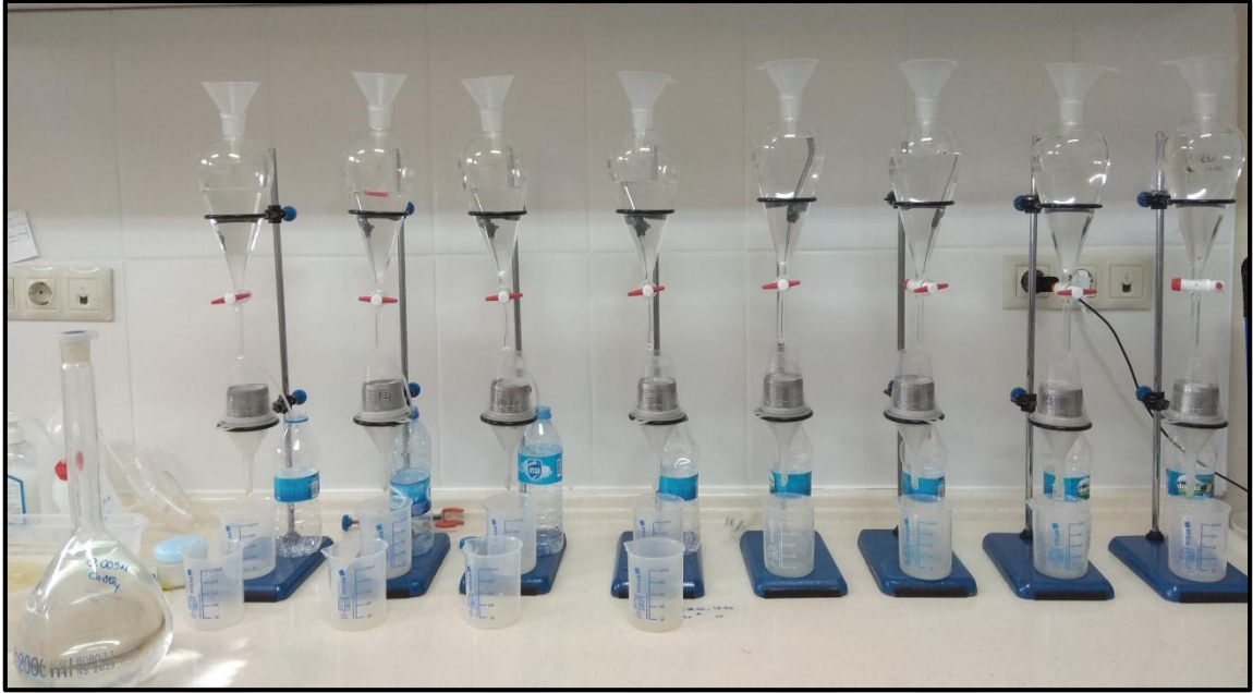
Şekil 14. Hidrolik iletkenlik analizi için kurulan düzenek
