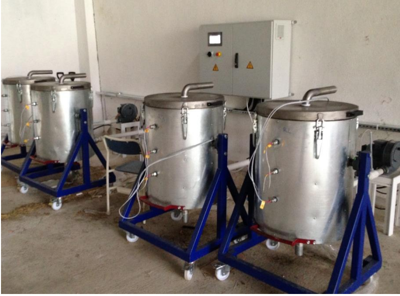
Şekil 1. Denemede kullanılan otomatik kontrollü kompost reaktörleri
