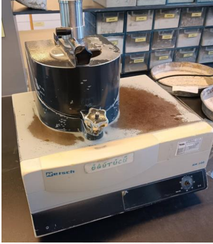
Şekil 7. Kurutulan tozların öğütme süreci
